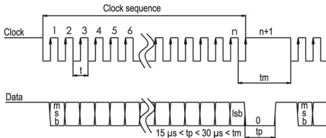
**Protocollo di trasmissione SSI - Trasmissione multipla:**
